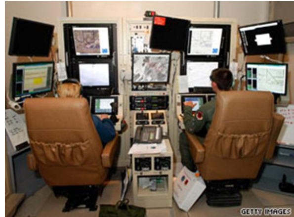
À l'intérieur d'une station terrestre de contrôle de drones.
